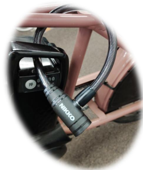
バッテリーケースとフレームを 施錠した様子
